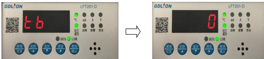
例如第一路温度显示，先显示类型和通道Ta, 过1秒显示数值0，持续2秒。然后进入第二路温度显示，以此循环显示各个类型数值。当界面显示到各自类型数值时右侧指示灯也对应的亮起。
